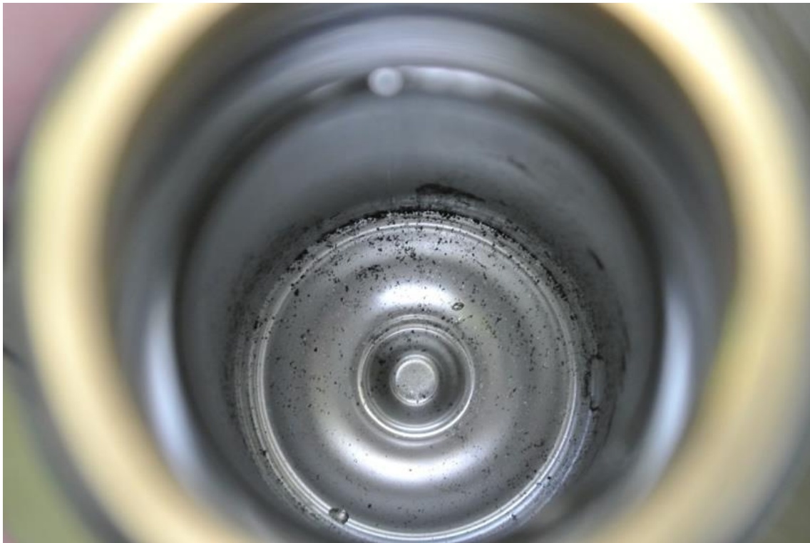
Фото 5. Наличие сора, появившегося на дне криодеструктора после всего одной заправки жидкого азота устройством, не имеющим фильтра.
